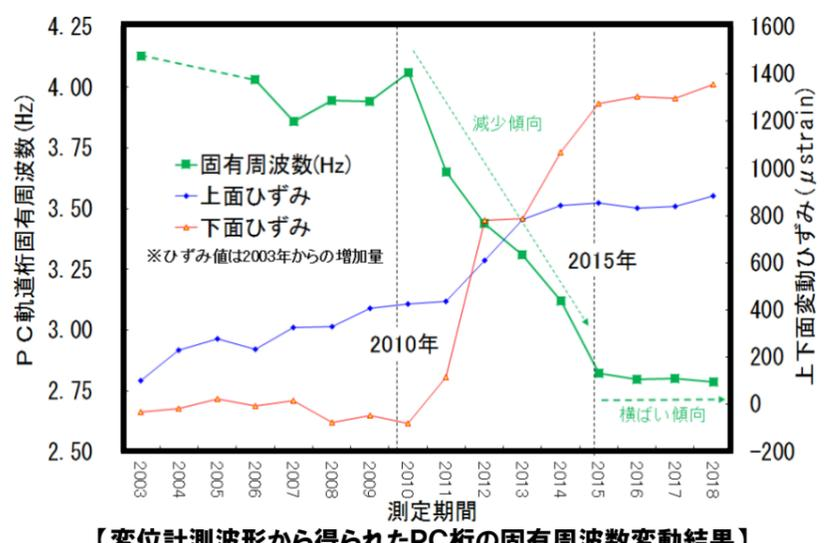
できます。また特筆すべきは、この衝撃影響には周期性があることが確認できたことです。この成分を周波数分析すると、PC桁の固有周波数が大きく変動することが確認できました。特に下縁ひずみが増加する2010年までは、載荷試験から得られた固有周波数は4.0Hz程度と安定した傾向が確認できましたが、2010年以降、下縁ひずみの増加に伴い、固有周波数が大幅に減少傾向に転じていることが確認できます。固有周期と桁剛性は密接な関係にあり、この固有周期を把握することで、ASR膨張により劣化するPC桁の耐荷性能が管理可能となりました。このように根気強く、地道な継続的調査が、未知なる劣化メカニズムを解明した事例です。
