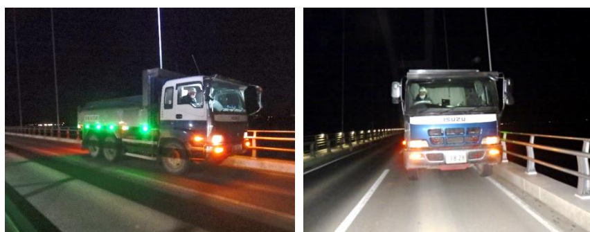
使用した試験車両（総重量：21.020tf）
