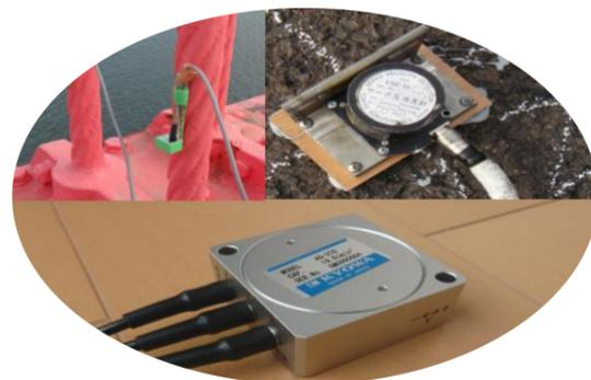
ロードセルは、力の大きさを電気信号に変える変換器で、力に比例して変形する起歪体とその変形量“ひずみ”を測定するひずみゲージからできています。左写真は、鋼製杭に作用する変土圧測定時に使用したものです。
