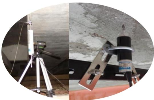
構造物の相対変位、不動点からの絶対変位等を電圧に変換して測定するセンサーです。変位の測定範囲は数mmから数mまでの広範囲に及び、その変換方式も各種あります。
