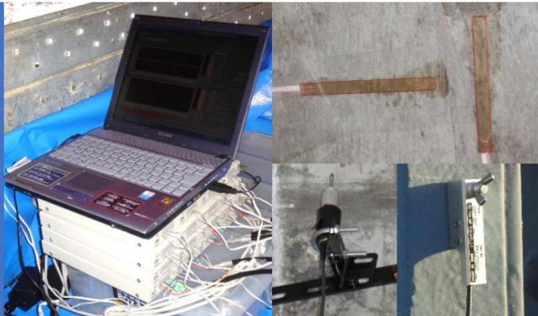
上晴は、構造物の特性（劣化状態、材質等）を踏まえて多種多様なセンサーを用いて応力測定を実施しています。ここでは上晴が実施している、一般的なひずみ及び変位等の測定に使用するセンサーを紹介します。
