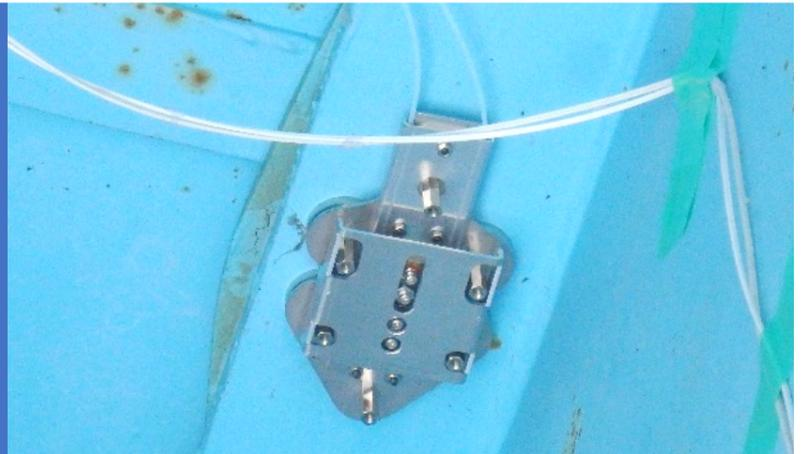
上晴では、構造物の的確な応力挙動を評価するため、実構造物に外力を作用させた際の変形挙動を計測し、耐過性能を的確に把握しています。使用するセンサーは、応力変換可能なひずみセンサーや剛性評価が可能な変位・振動センサーを使用しています。また、ひび割れ発生及びケーブル破断時に発生する弾性波をキャッチするAEセンサー等を取り扱っています。これらは既に確立された計測システムの基、高精度な計測が可能ですが、各々独立したシステムであるため、機材が多種多様化となり、必然とハイコストパフォーマンスとなり、特異な業務での使用に特化する傾向があります。上晴では、これら計測したい複数項目を一括したセンサーで計測可能になるよう『高性能センサー開発』に力を注いでいます。
