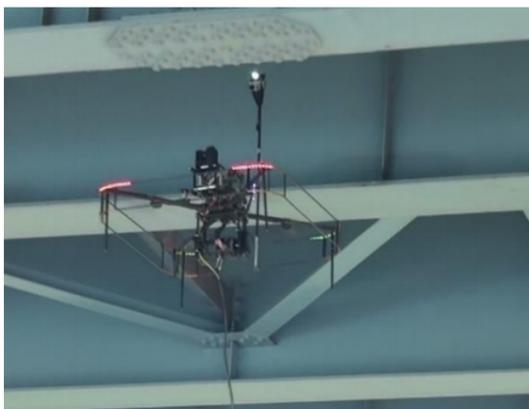
近年、道路規制を伴わないロボット活用による橋梁点検が盛んにおこなわれています。左写真は飛行型タイプのドローンを活用したもので、右下写真は懸垂型のアームにカメラを配置してアーム上をカメラを移動しながら前進するロボットです。これらのロボットは従来の特殊車両に代わる点検方法として開発されています。しかしながら操作性の難しさ、定点観察の観点で従来の近接目視点検をカバーするまでに至っていない状況にあります。またコンクリート構造物に不向き等の問題点を抱えています。
